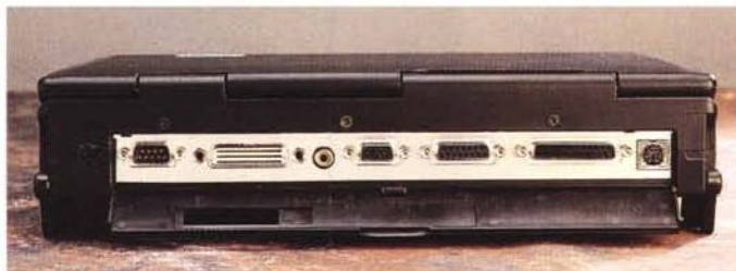
Il retro della macchina è interamente occupato dai connettori per le periferiche esterne tra cui si nota il pin jack del segnale Video PAL.
